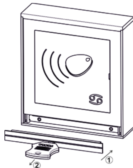
Obr.8 Montáž uzamykacej lišty
